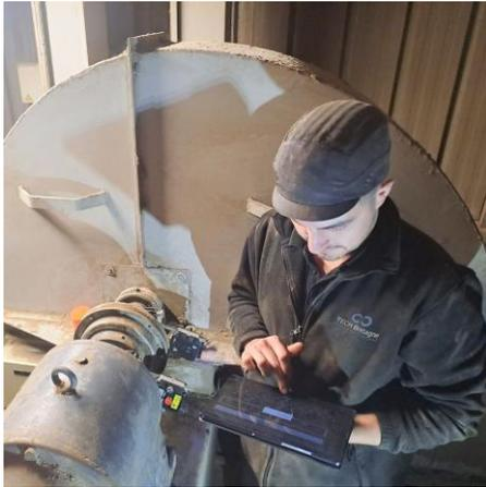
Maintenance de machines tournantes (pompes, ventilateurs...) avec lignage laser
